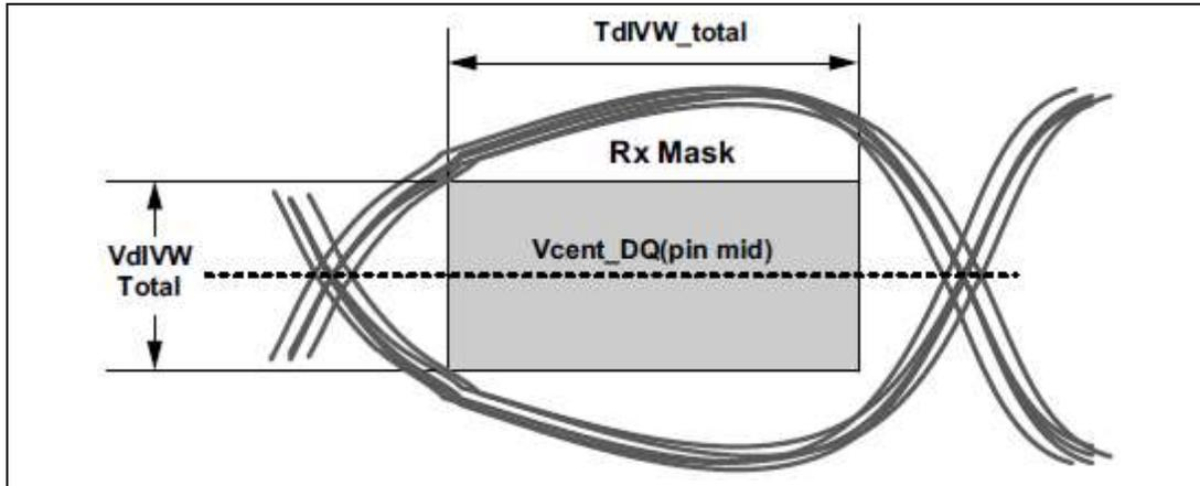
Figure 173 - DQ Receiver (Rx) mask
