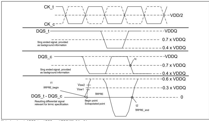
**Note:** Low Level of DQS\_t and DQS\_c =  $VDDQ/(50+34) \times 34$ =  $VDDQ \times 0.40$
