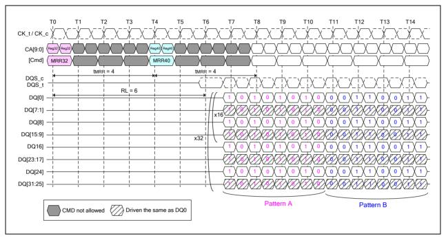
Figure 37 - DQ Calibration Timing
