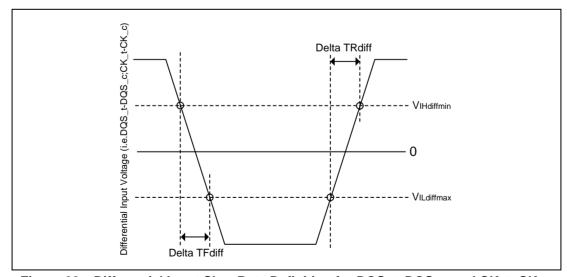
Figure 68 - Differential Input Slew Rate Definition for DQS\_t, DQS\_c and CK\_t, CK\_c
