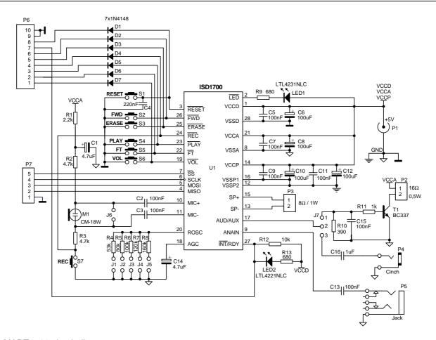
Fig.1. MART1700 circuit diagram.
